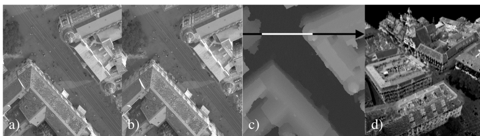
Abbildung 21: (a) linkes Bild; (b) rechtes Bild; (c) Parallaxenbild; (d) 3D-Punktwolken
